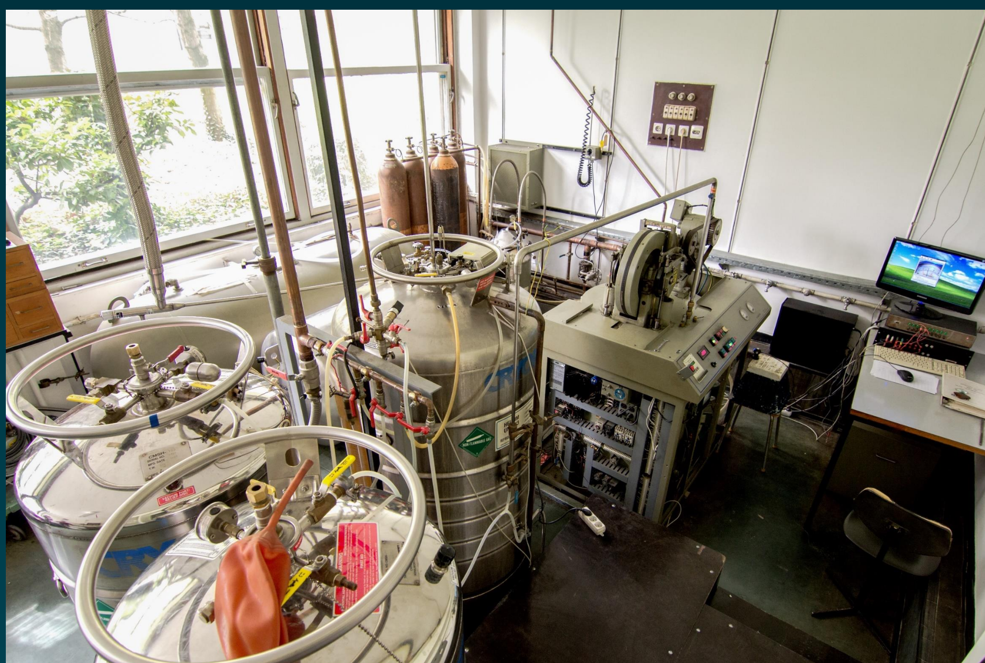
„Cold Box” ukapljivač helija M1410 (Koch Process systems)
